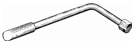
Рис. 190. Ключ торцовый 48001-1-096МД для гайки дет. 237-15-65
